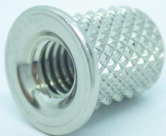
特注インサートナットでよくあるのが、ツバ付き形状であったり、頭部が小判形状やDカットの場合です。こうしたインサートナットでは、切削よりも鍛造の方が安くなるケースが多くなります。
