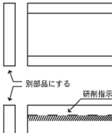
上図の様にポケット壁を別部品にすることによって、平面研削盤での加工が可能となり、別部品とするほうがコストダウンにつながります。
