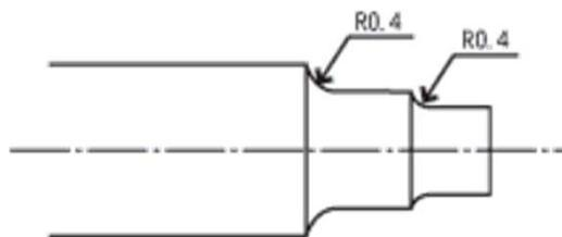
汎用の旋盤チップのRに合うようにR1.0⇒R0.4と変更することで、旋盤チップを変更せずに、加工を行うことができ、工数削減によるコストダウンを可能としています。
