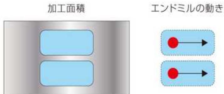
穴加工において、長穴が2つ隣接する構造では、2穴の間があまりにも薄いと壁が破損する恐れがあります。また、ドリルとエンドミルの位置あわせを2度行わなければならないので、工数がかかってしまいます。
