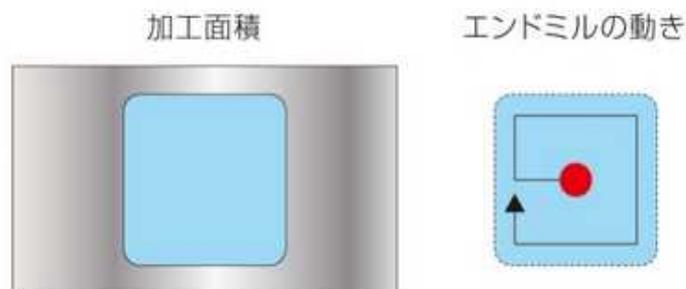
穴加工を行う場合には設計段階で穴の形状について考慮する必要がある。上記の例では、図のように、2つの長穴を1つの長穴に一体化することで、ドリルとエンドミルの位置あわせの回数を削減し、エンドミルのみの加工とすることで、工具交換回数を削減することができました。
