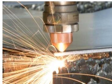
穴あけ加工を行う上では、要求精度によって工数が変わることを意識して設計をする必要となります。要求精度が100 $\mu$ m台であれば、レーザーでも問題無く加工することができます。したがって加工時間の削減となり、コストダウンにつながります。
