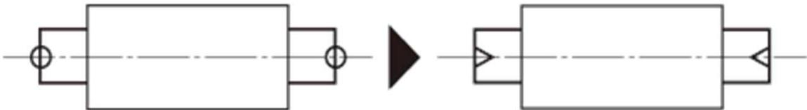
円筒研削の場合、基本的に両端面にセンター穴が必要です。設計段階においては、図面上でセンター穴に関するコメントを載せ、センター穴不要の場合にはその旨を示す指示が必要になってきます。
