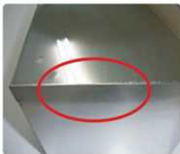
YAGレーザー溶接後
